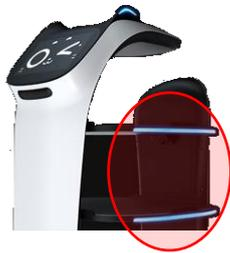
トレーの上にある商品の有無を検知するセンサが搭載されているので、ロボット自身で配膳完了の判断が可能。同時にLEDでどのトレーが対象かを通知させる役割も担っています。
